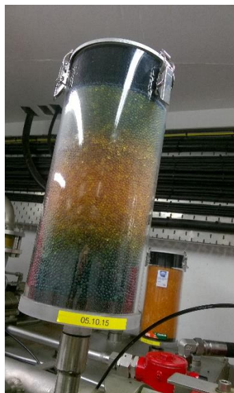
2. Beladung von oben wird langsamer und beginnt auch von unten. Anlage ist effektiv geschützt!
