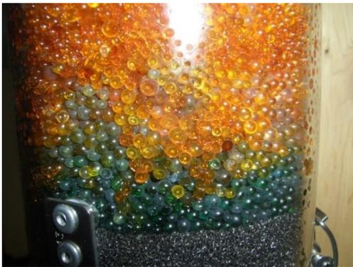
**4. Adsorber, bzw. das Trockenmittel sind verölt.** Mit Öl beladenes Silicagel hat die Fähigkeit Wasser zu adsorbieren verloren. Die Poren sind imprägniert und somit verschlossen. Dabei erfolgt der Farbumschlag nur teilweise, stark verzögert und mit einem anderen Farbton.
