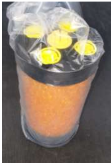
3. Adsorber wird zusätzlich in Beutel verpackt.
