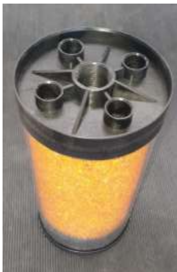
1. Adsorber nach dem Befüllen und Verkleben
