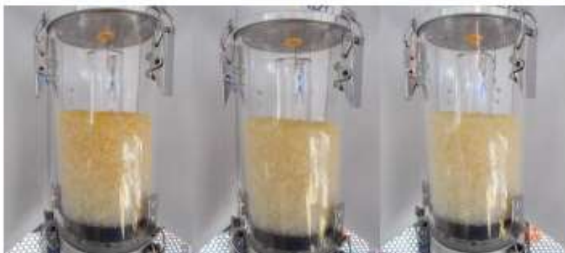
Abbildung 1: Gesamtbeladung des Adsorbers, bei 10%, 20% und 30% der Trockenmasse Deutlich sichtbar: Vorteil des längeres Wartungsintervalls von Silicagel Orange
