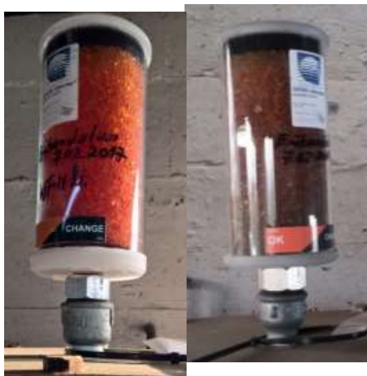
Abbildung 3: Links: Adsorber VV-DV 2L (mit Ventilen) Rechts: Adsorber VV-D 2L (ohne Ventile) Einsatz nach ca. 9 Monaten auf Getriebe
